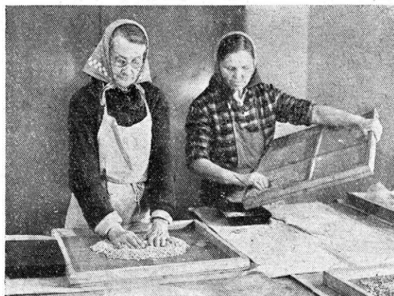
Obr. 9. Ruční odkličování sladů na sítěch (na počátku řešení úkolu)
