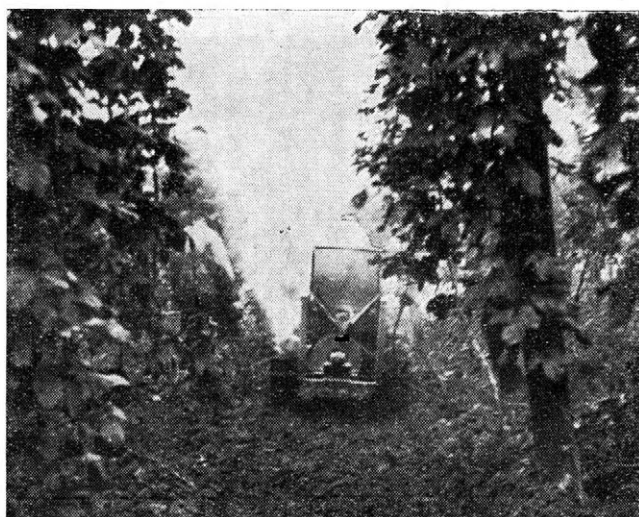
2. Poprašování chmele pozemním poprašovačem neseným na pásovém traktúru PT 10
