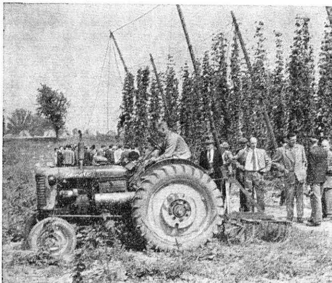
1. Široké spony umožňují mechanizaci kultivačních prací normálními traktory. Na snímku pořízeném na pokusných chmelnicích VÚCH ve Stekníku u Žatce je zkoušení nové plečky pro spon 240 × 240 cm
