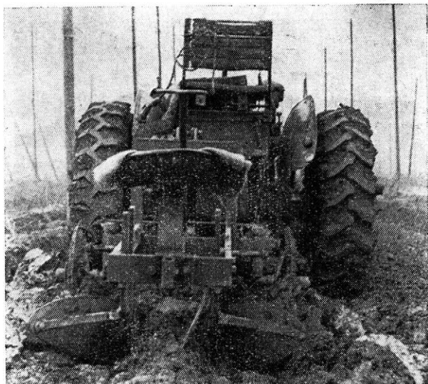
2. Nesený oboustranný říditelný pluh na traktoru Z 25 K pro podzimní a jarní orbu. Za radlice se při jarní odorávce montují odhrnovací tělesa za účelem současného odkopání rostlin (snímky Vlad. Vaněk)
