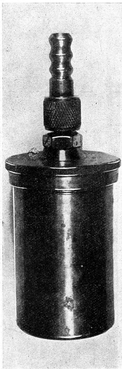
6. Vodní tryska zadešřovacího přístroje. (Foto M. Novák, VÚRV, Ruzyně)
