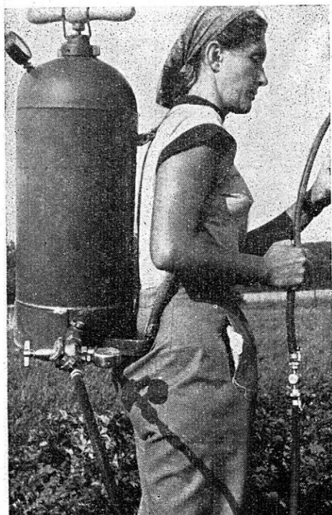
9. Zádová stříkačka s redukčním ventilem, upravená jako zásobník vzduchu pro atomisaci aerosolových roztoků v přenosném toximetru. (Foto Dr. Koula, VÚRV Ruzyně)
