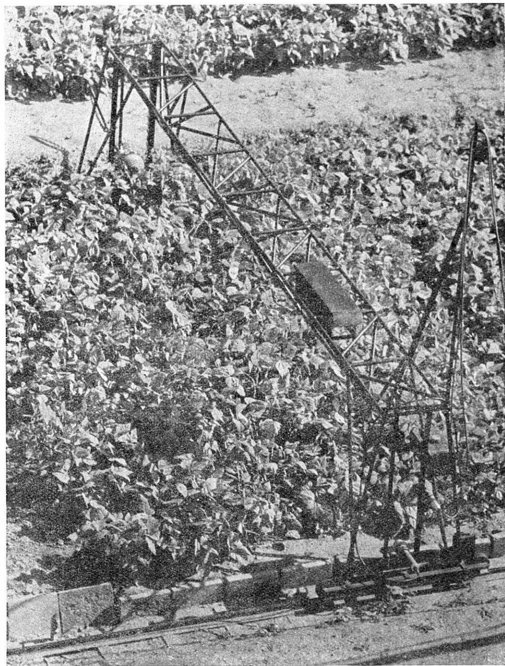
Obr. 3. Zjišťování zelené hmoty na podélných pokusných parcelách prozařováním gama zářením pomocí měrného mostu
