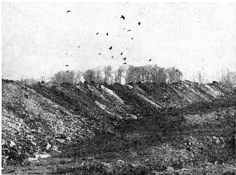
10. Nejjednodušší metoda výroby průmyslového kompostu. První zakládka surovin ve slovenském závodě v Bratislavě-Petržalce. Zde zužitkují i prosevy ze starých skládek odpadů městských smetků a popelů
