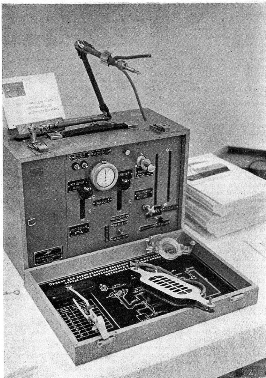
11. Sovětský přístroj IFP-1 pro polní stanovení intenzity fotosyntézy radioaktivním uhlíkem C^{14} . Vpředu je speciální listová asimilační komora Semeněnkova (1957) se šedým stupňovitým klínem, určená k rychlému stanovení závislosti fotosyntézy na intenzitě světla. (Ze stáže MPVP v Kyjevě 1960)
