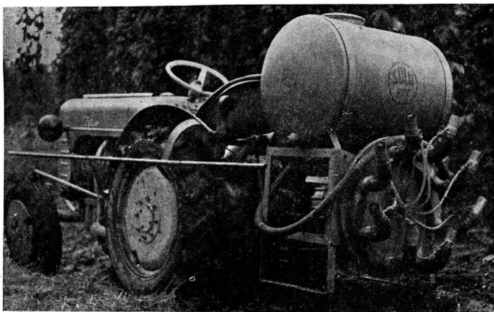
Obr. 3. Úsporný postřikovač zn. Solo-Rex nesený na úzkorozchodném traktoru Zetor-Minor. (Foto Vl. Vaněk)
