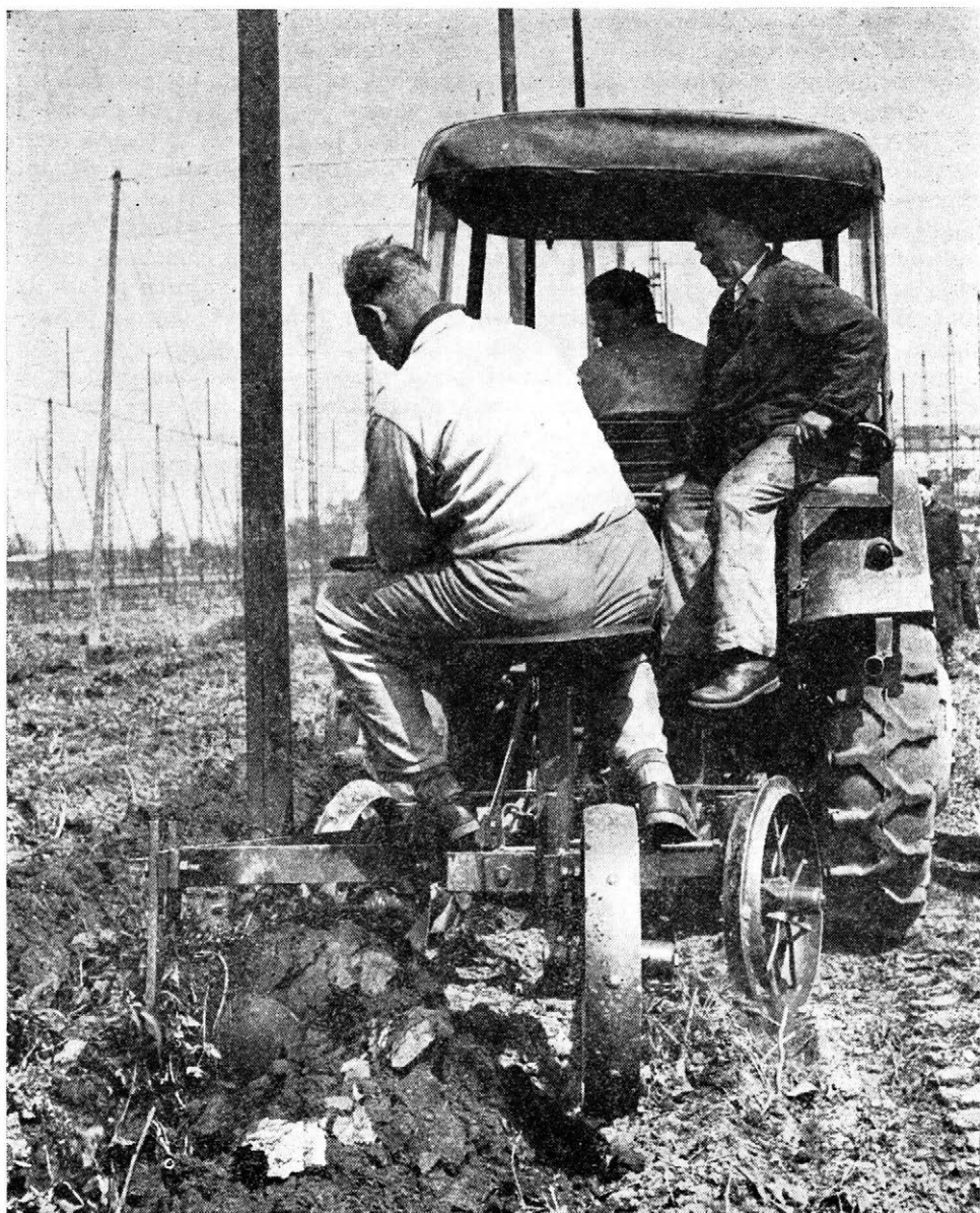
Obr. č. 3.: Odorávání sloupových řadů pomocí univerzálního pluhu za traktorem Zetor Super 35 v úzkých sponech chmelnic
