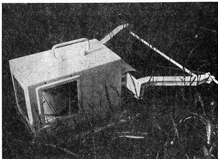
Obr. 2. Ovlhograf k zjišťování délky doby ovlhnutí porostu. Foto Píša
