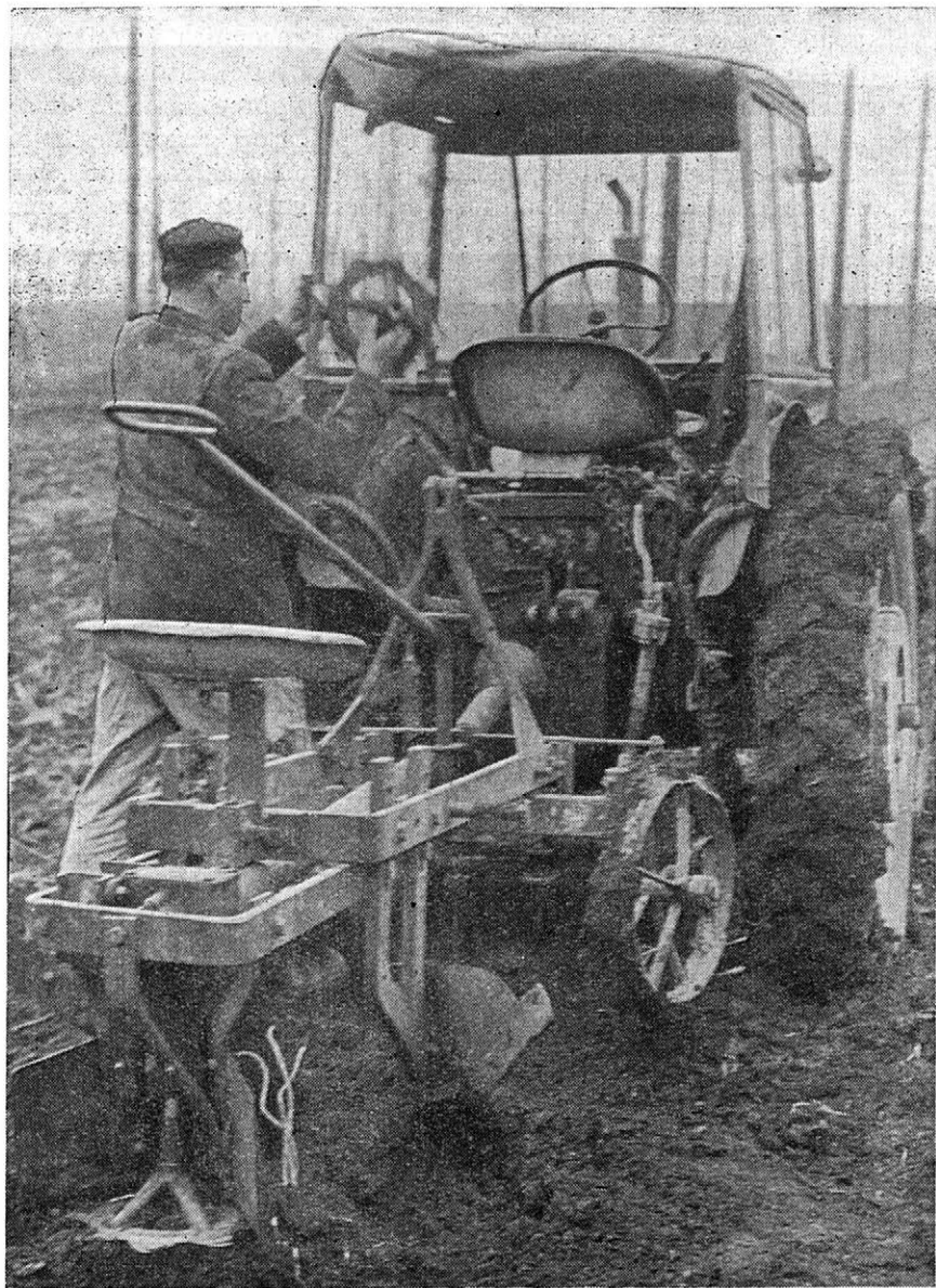
Obr. 2. Polonesený říditelný pluh do chmelnic s přidavným zařízením pro řez chmele
