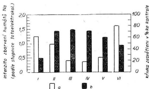
Graf 2. Intenzita zbarvení roztoků humátů sodných a stupeň jejich oxydace peroxidem vodíku. Humáty: I. černé uhlí, II. hnědé uhlí, III. nížinná rašelina, IV. severní podzol, V. černozem, VI. šedozem; a) intenzita zbarvení roztoků, b) zesvětlení humátů sodných 5% roztokem peroxysu vodíku v procentech ke kontrole
