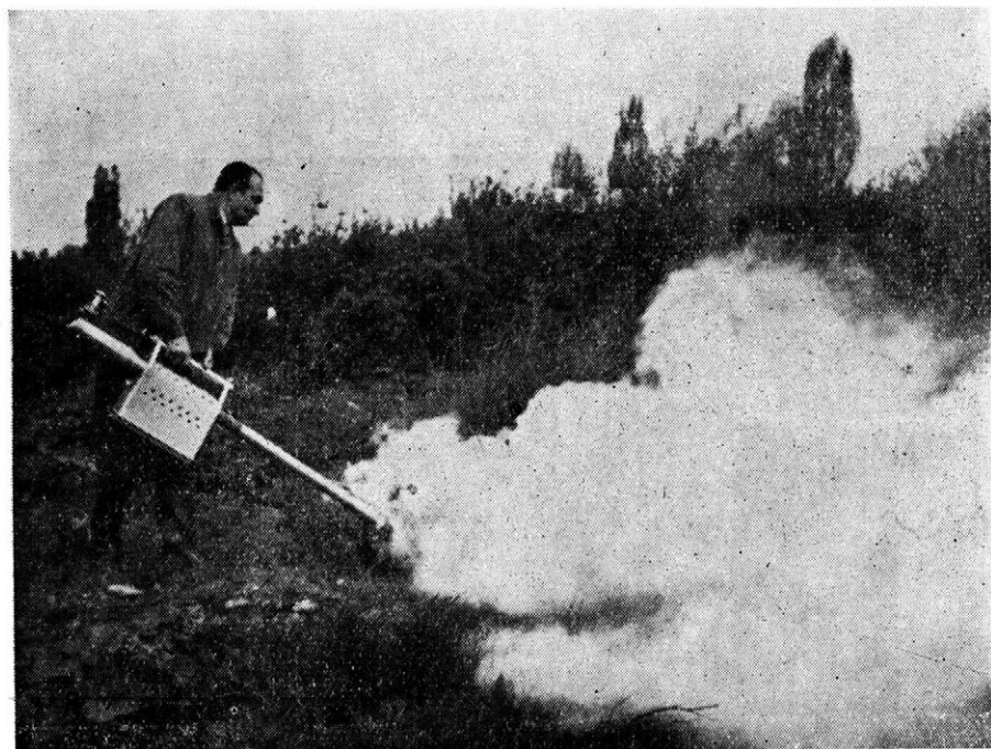
Obr. 5. Generátor RAG I s produkcí teplého aerosolu při ohniskovém hubení plevelů. Foto M. Novák, ÚVÚRV Ruzyně
