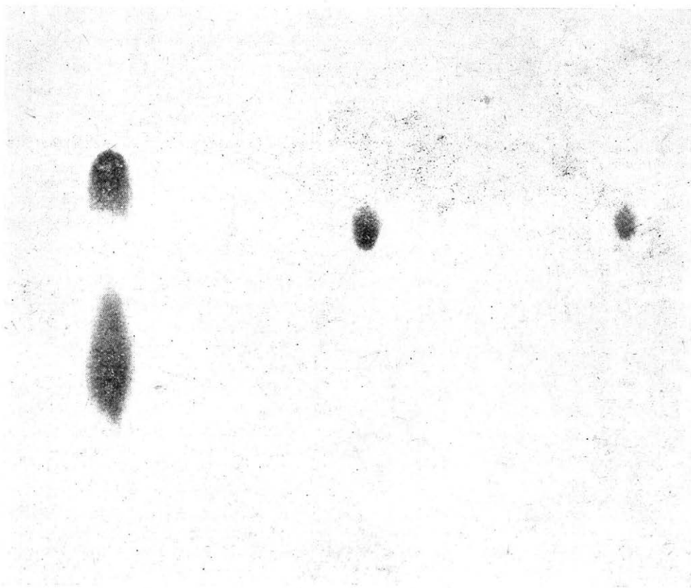
1. Fotografie chromatogramu obchodního preparátu WR 62 a extraktů z listů pšenice a ječmene za 24 hodin po aplikaci CCC. První v pořadí je preparát WR 62 (skvrna s nejnižší hodnotou R_f není zachycena), druhá skvrna je extrakt z pšenice a třetí z ječmene
