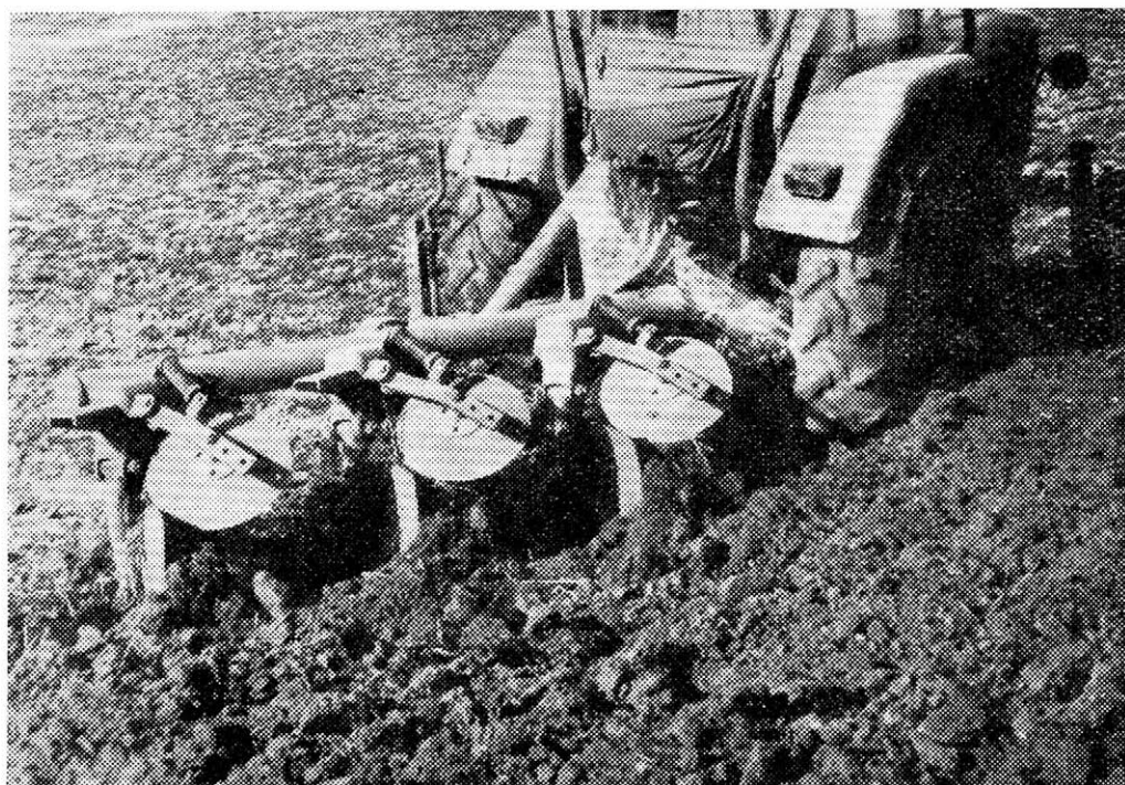
11. Pohled na upravený pluh pro zaorávku slámy — přídavná kotoučová tělesa. — Adapted plough for the ploughing-in of straw—additional disks
