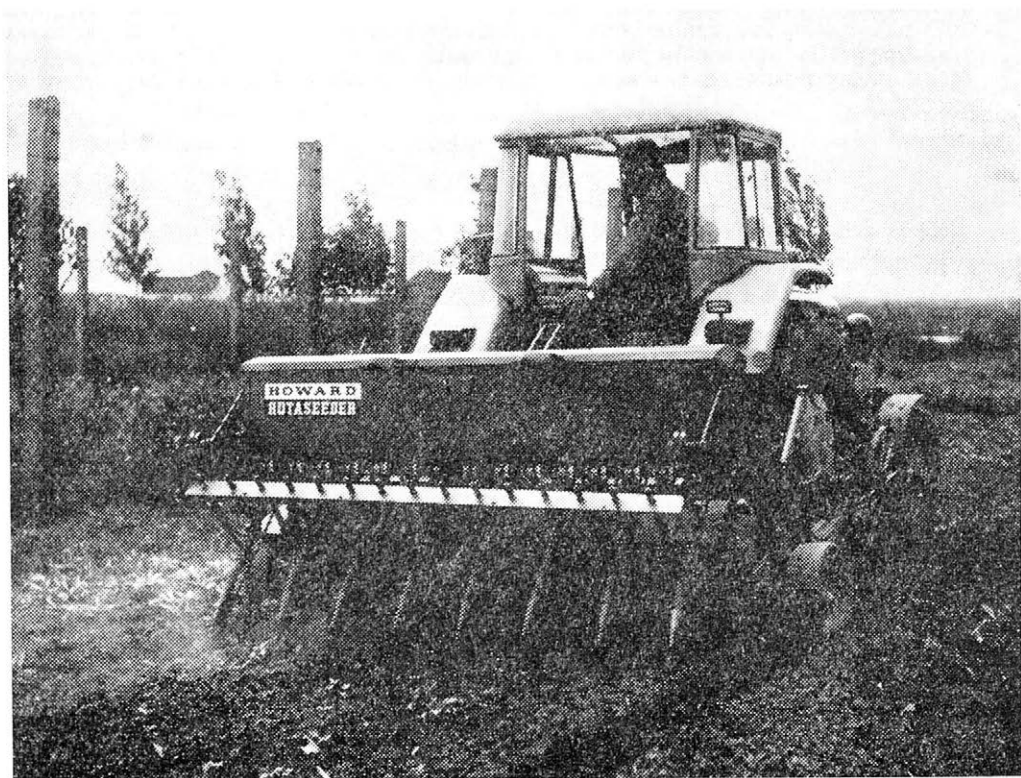
1. Pohled na secí stroj Rotaseeder, použitý při setí do nezorané půdy. — Seeding machine Rotaseeder used for the sowing in unploughed soil
