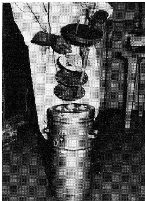
1. Upravená Dewarova nádoba pro sledování průběhu zrání kompostu. — Adapted Dewar's flask for the examination of the course of compost ripening.
