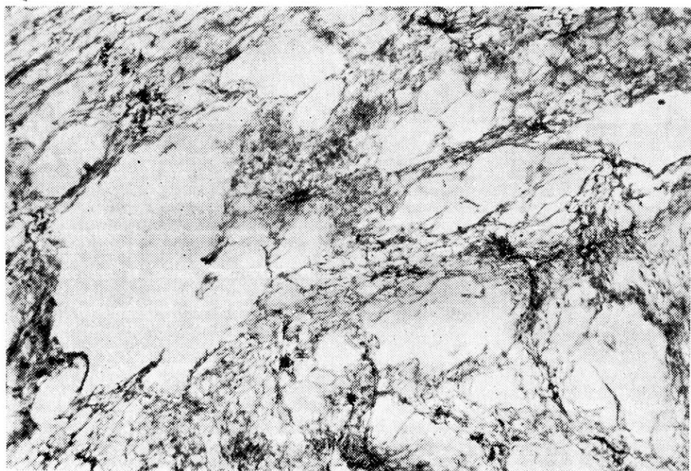
6. Materiál sušený expanzní metodou s parním ohřevem. Pletiva destruovaná, roztrhaná, většinou nelze rozlišit buňky. — Material dried by the explosion puffing method with steam heating. Tissues destroyed, torn, cells cannot be discerned in most cases
