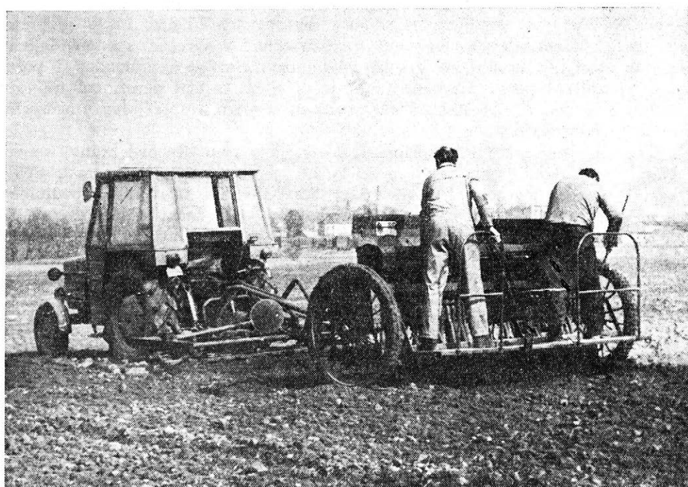
1. Agregát kývavých bran a secího stroje. — The aggregate of oscillating harrow and seeder
