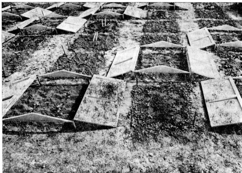
1. Dešťové clony na pokusných dílcích. — Rain screens on trial plots
