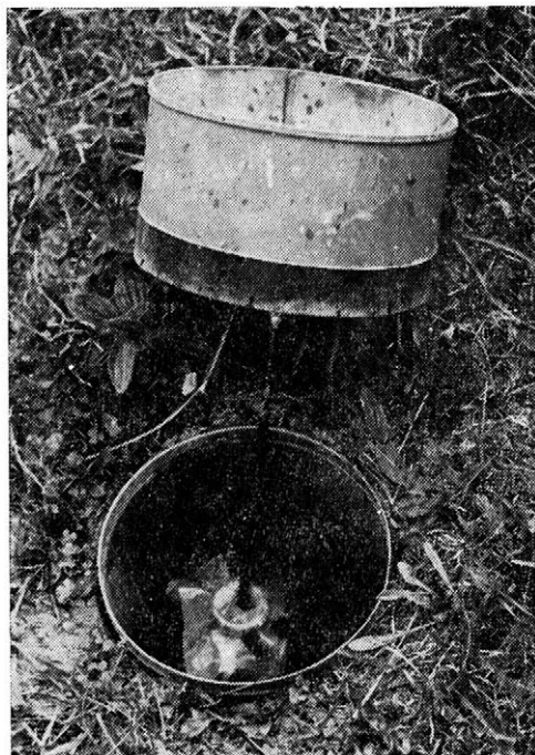
1. Modifikovaný totalizátor, ktorým sa merali v 14-denných intervaloch atmosférické zrážky na všetkých stanovištiach — Modified totalizer used for the measurements of precipitation at all sites in 14-day intervals
