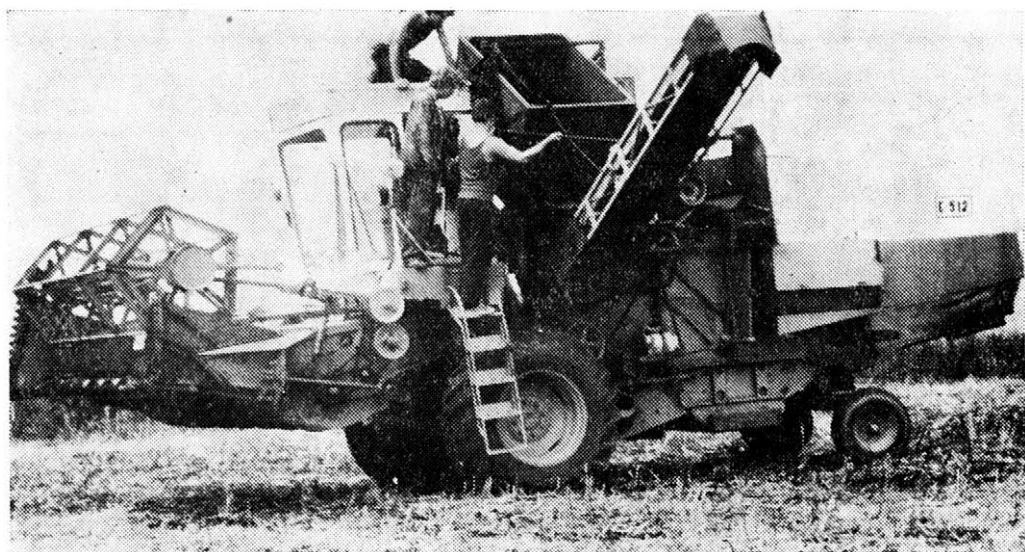
1. Modelová úprava E-512 (1983), pohľad z ľavej strany. Znázornené vyklápanie zásobníka a pásový dopravník. Vpredu namontovaný model adaptéra pre zber bôbu a repky. Porast bôbu v JZD Havříce — Model adaptation of the E-512 combine (1983), left side view. Grain-tank emptying and the belt conveyer. The adapter for bean and rape harvesting mounted in the front. Bean stand on the Havříce co-operative farm
